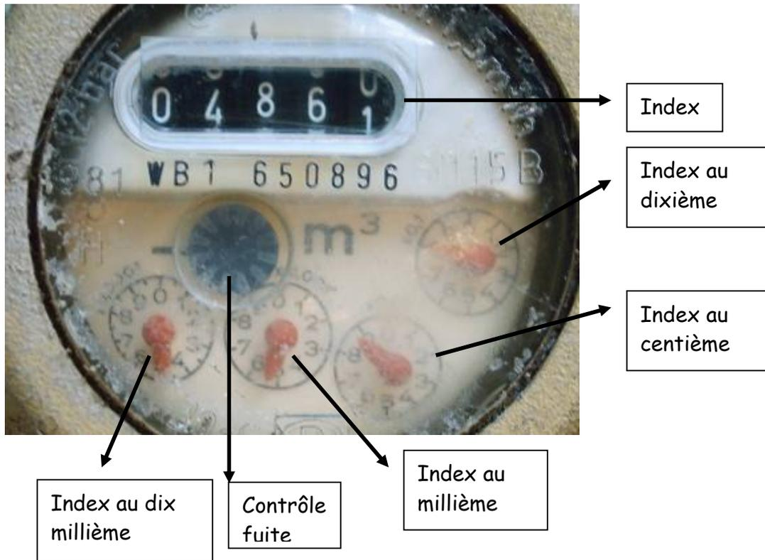
Les chiffres en noir désignent l'index (partie entière). La partie décimale se lit via les différentes aiguilles. Une roulette est également présente sur le compteur. Elle permet de vérifier si de l'eau est utilisée et donc de déceler des fuites éventuelles.
